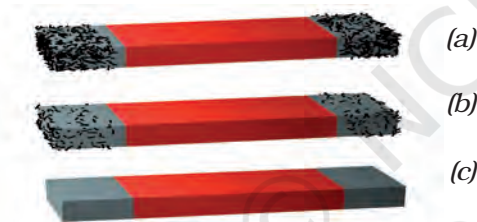
चित्र 10.6 चुंबक (a) पर्याप्त लोहे के बुरादे के साथ (b) कुछ बुरादे के साथ (c) बिना बुरादे के साथ
